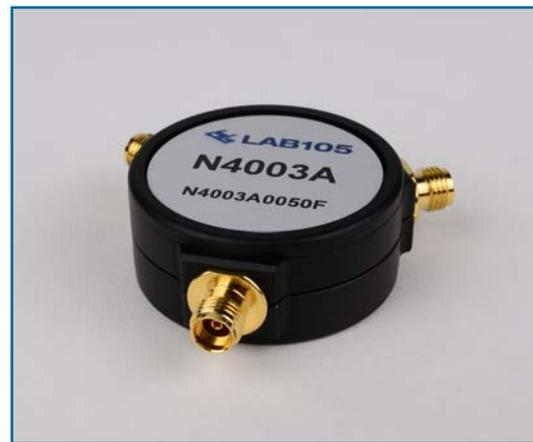
N4003A、N4006A 和 N4008A 所支援的頻率響應分別為 3GHz 的，6GHz 的和 8.5GHz。這些的校準套件都同時包括了開路(OPEN)、短路(SHORT)和負載 (LOAD) 標準件，而且它們都一起被封裝在同一個圓形金屬外殼內，不僅堅固耐用，而且也很更容易使用。本套件除了包含了上述三種校驗標準件外，同時也提供一個精密的 PC 3.5(母)對 PC 3.5(母)轉接頭，可以用在全雙端口校驗(full 2-port calibration)時使用。
