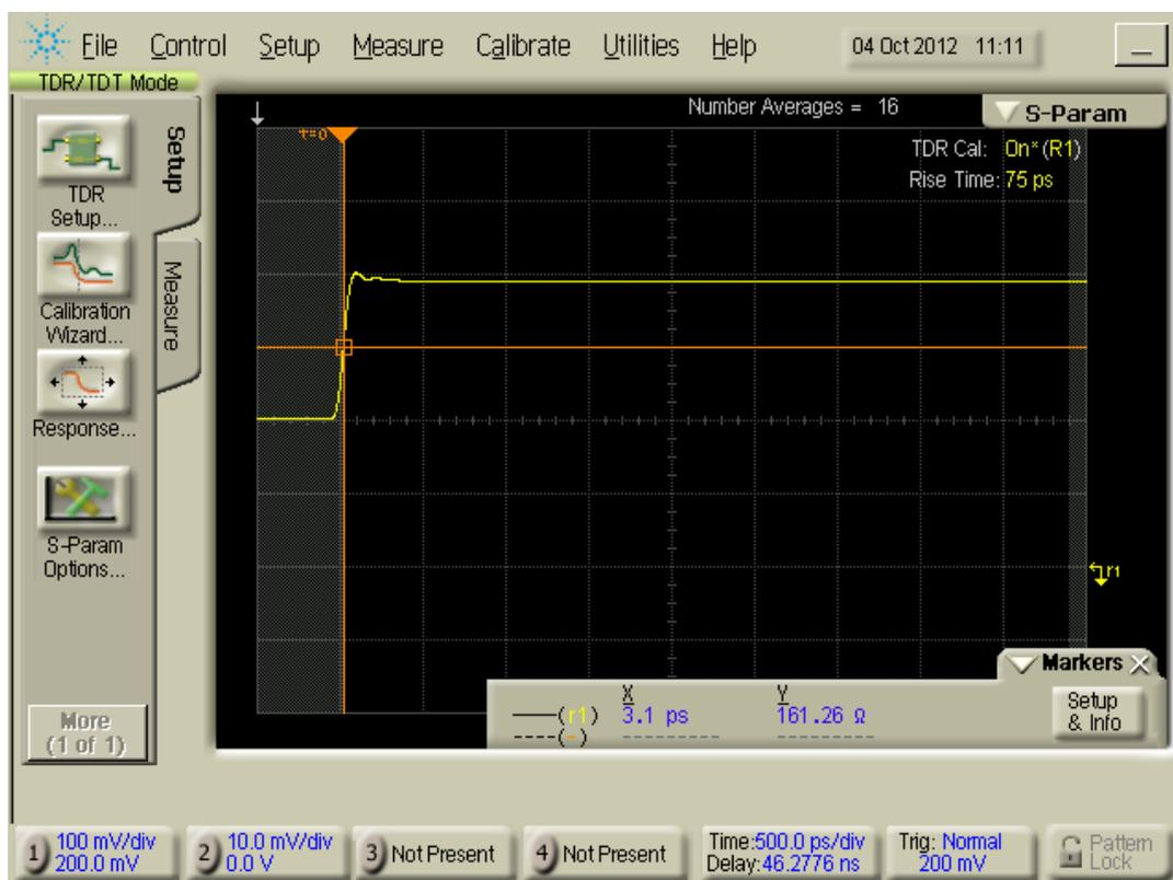
透過 Flash-Short 可以建立跟待測物 Launch Plane 完全對齊的時間基準平面，也就是圖上跟步進脈衝(Step Pulse)上升緣對齊的左側灰色區域。
